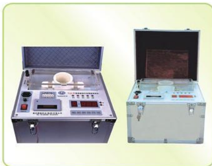
YJJ-II系列电脑控制全自动试油器 YJJ-II series automatic oil tester
